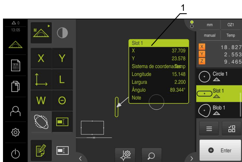
Figura 77: Vista de elementos com informações de medição sobre um elemento
