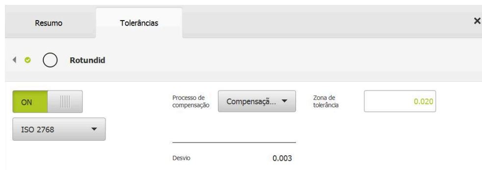
Figura 73: Resumo das Tolerâncias de forma com tolerância de Rotundid ativada segundo ISO 2768
