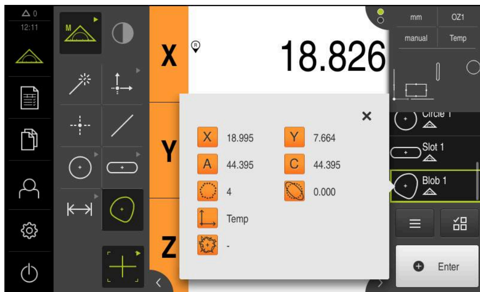
Figura 48: Selecionar o elemento Blob na lista de elementos com Pré-visualização de elementos
